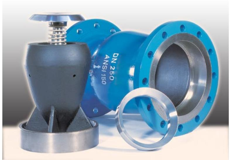
Die hohe Wirtschaftlichkeit der Düsenrückschlagventile basiert auf sehr niedrigen Druckverlusten und wartungsfreier Konzeption. Bedingt durch kurze Schließwege und geringe bewegte Massen können die Ventile innerhalb von Sekundenbruchteilen schlagfrei schließen.
